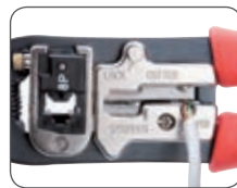
Зачистка круглого провода
